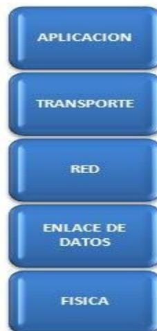
En esta figura se observan las diferentes capas del modelo TCP/IP en donde sus funciones y servicios son variables, cada capa se ocupará de su nivel inferior para solicitar dichos servicios y del nivel superior para devolver los resultados.
